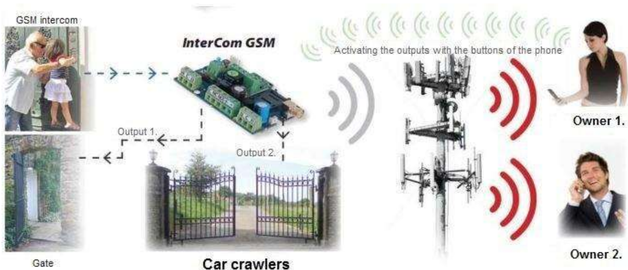
Figura 1: Funzionamento del dispositivo
